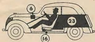
Voiture transformée pour le transport des colis, marchandises, échantillons grâce à l'enlèvement réalisé en un instant du coussin et du dossier arrière. Les 600 litres de capacité représentent la zone teintée en noir, limitée à la hauteur du dossier avant. De telle sorte que le chargement ne gêne en rien le conducteur qui conserve intacte sa visibilité et qui ne risque pas le déplacement des colis transportés.
